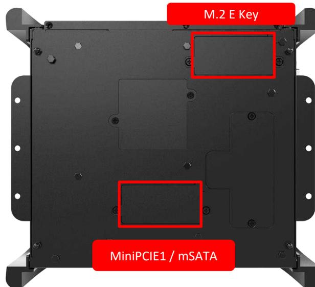
2. Insert mini PCIe card/mSATA module at a 45 degree angle.
